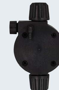
PVC pompkop voor hoge debieten ( 20 l/u to 50 l/u) compleet met keramisch bal terugslagkleppen. FPM of EPDM dichtingen
